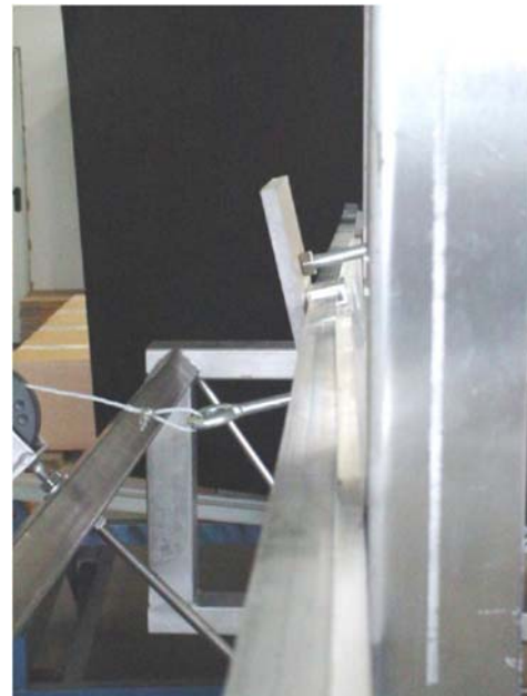
Bild 51: Profilverformung aus Eigenlast Platte
